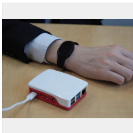
リストバンド型端末と、脈拍データを集約してサーバーに送る小型機器
